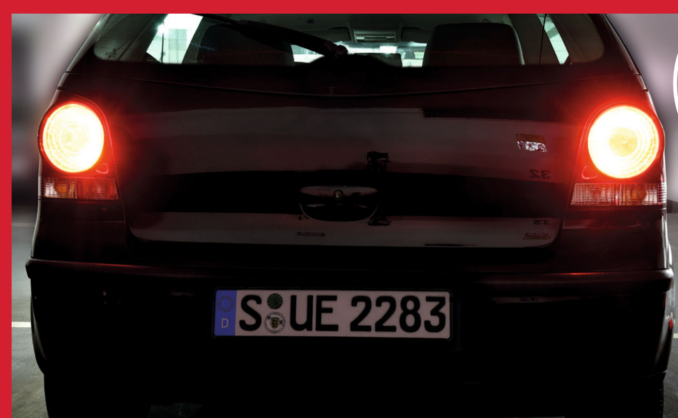
Kennzeichenbeleuchtung ohne Funktion
