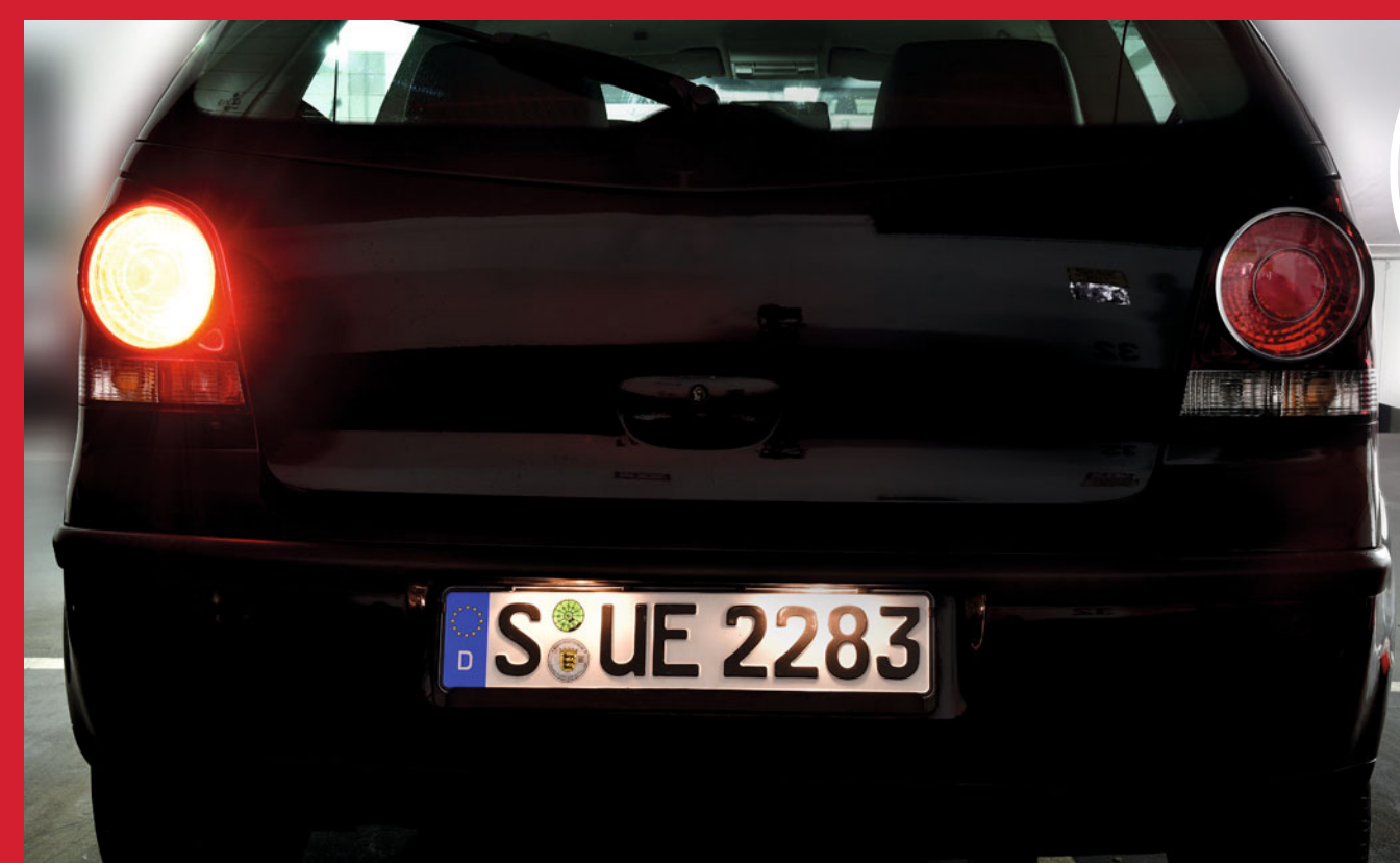
Eine Schlussleuchte ohne Funktion
