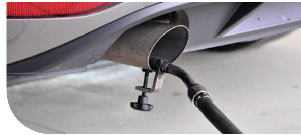
Dieselabgassonde im Endrohr eines Kfz.
