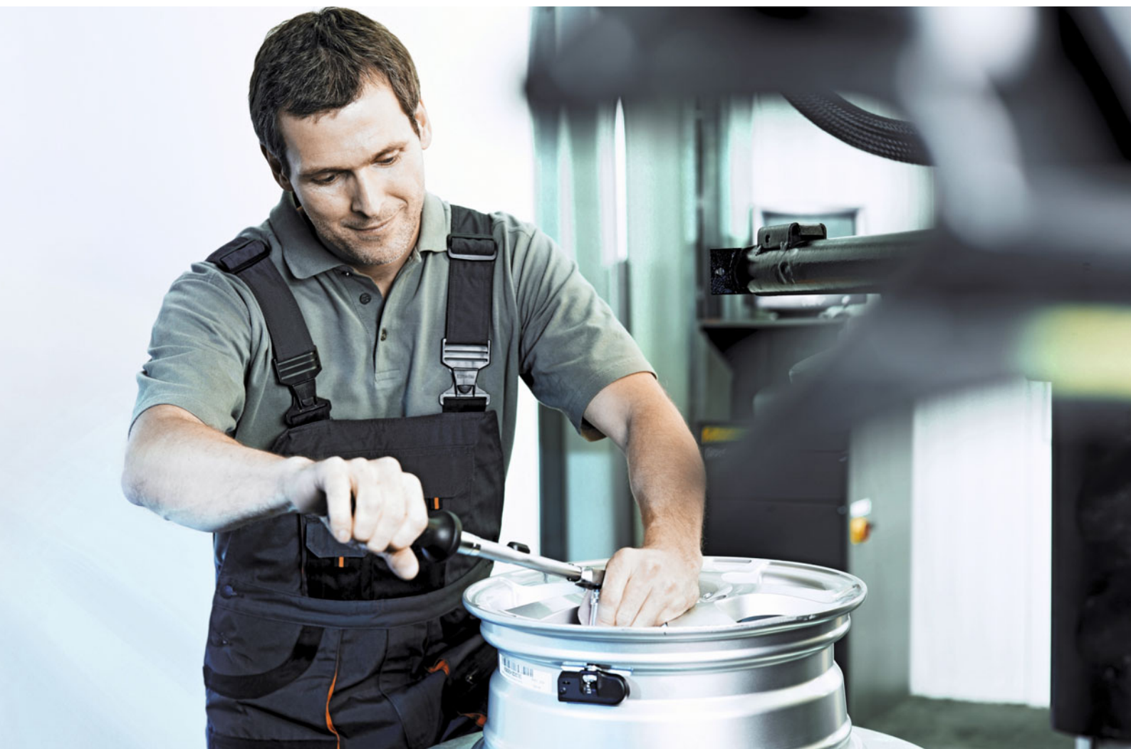
Montage eines RDK-Sensors
