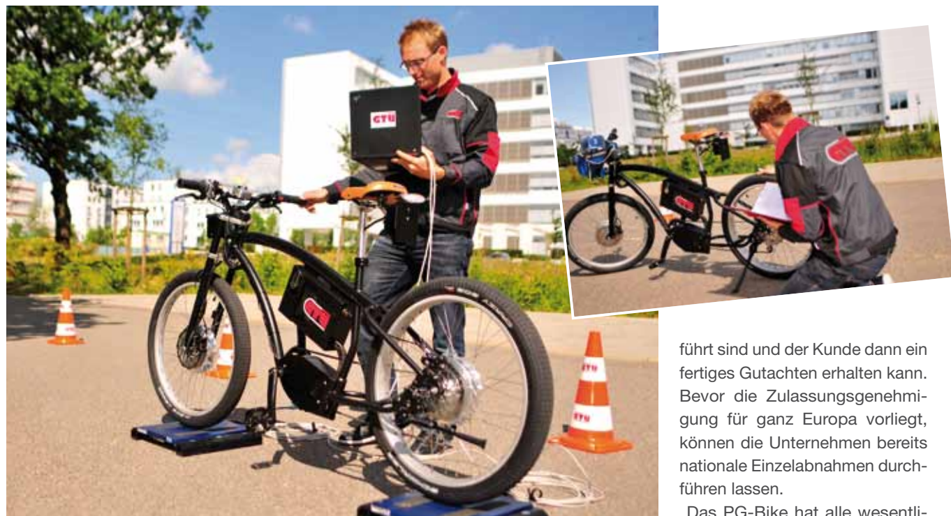
1 | Der GTÜ-Ingenieur überprüft hier, ob das Pedelec von PG Bikes der Richtlinie Gesamtfahrzeug Europa 2002/24 entspricht.
