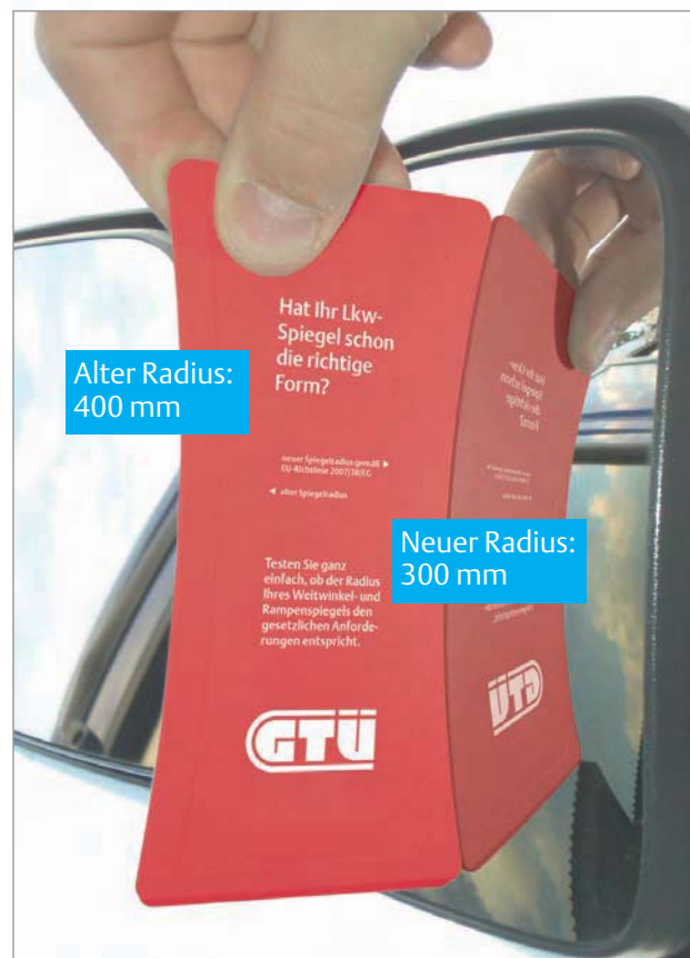
Halten Sie die Schablone senkrecht auf das Spiegelglas. Passt die Seite mit dem Radius 300 mm ohne Spalt auf das Glas, sind bereits die neuen Spiegelgläser montiert.
